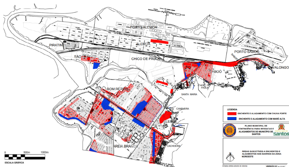
Figura 8. Delimitação das áreas alagáveis e/ou inundáveis nos bairros da Zona Noroeste
